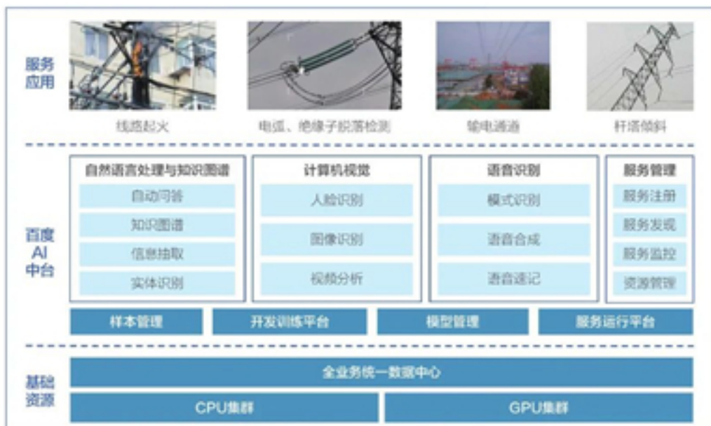
图 AI 中台实现智能电力运维监测
