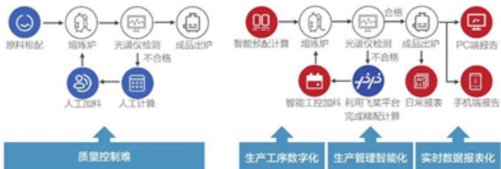
图 传统熔炼方式与智能熔炼方式对比
