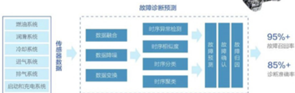
图 AI 中台助力发动机故障诊断及预测性维护
